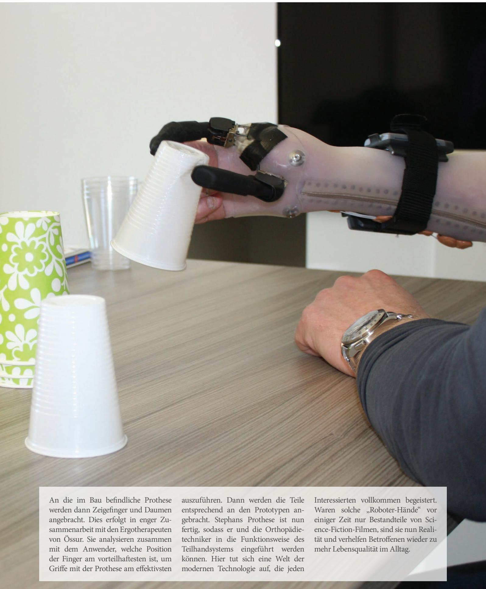
An die im Bau befindliche Prothese werden dann Zeigefinger und Daumen angebracht. Dies erfolgt in enger Zusammenarbeit mit den Ergotherapeuten von Össur. Sie analysieren zusammen mit dem Anwender, welche Position der Finger am vorteilhaftesten ist, um Griffe mit der Prothese am effektivsten
