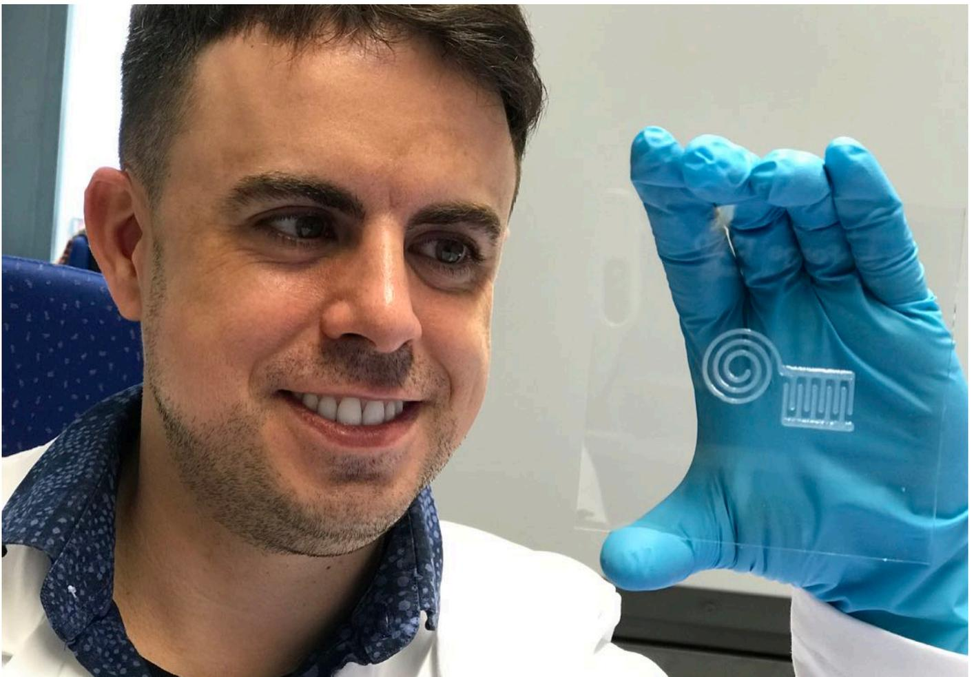
Empa-Forscher Gilberto Siqueira demonstriert den frisch ausgedruckten Nanocellulose-Schaltkreis. Nach einem Trocknungsprozess lässt sich das Material weiterverarbeiten.
