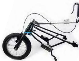
Der Nutzer hat die Möglichkeit, jederzeit frei zwischen zwei Fahrweisen zu wählen. Beim beidhändigen Antreiben tendiert das Rad zum Geradeauslauf, wobei weiterhin auf gewohnte Art gelenkt werden kann. Der zweite Fahrmodus entsteht durch Verwendung des Einhandlenkers, welcher die wichtigsten Funktionen vereint. Durch direktes und verzögerungsfreies Lenken kommt man kraftsparend und sicher voran. Die Bremse vermeidet heiße Hände in Bergabpassagen und macht das Aufkippen überflüssig.
