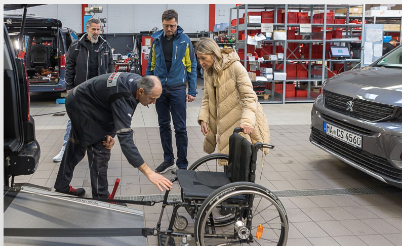
Am Ende müssen noch mal alle Befestigungen ordentlich geprüft werden, der Schalter für die elektrischen Gurte deaktiviert sein und der Passagier korrekt angegurtet sein
