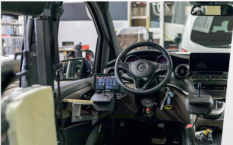
Neu für Benjamins Cockpit ist des PARAVAN Touch System. Damit kann er jetzt während der Fahrt bis zu 99 Sekundärfunktionen seines Fahrzeuges bedienen. Fahren wird er das Auto mit dem Fahr- und Lenksystem Space Drive und zwei Joysticks
