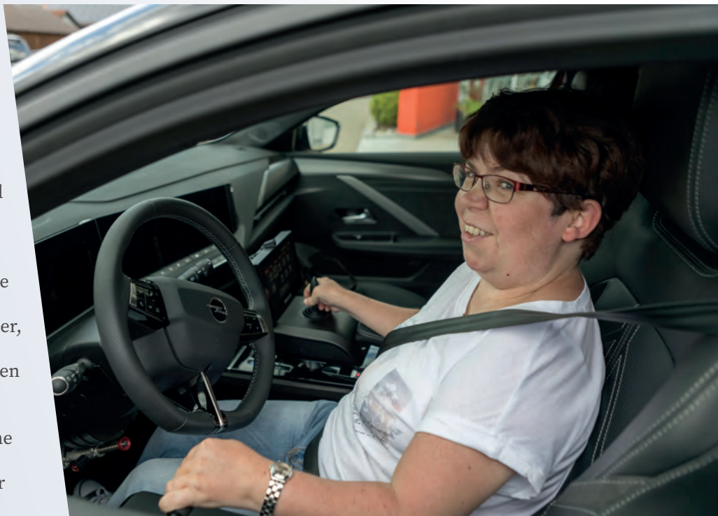
Nun kann Monika selbständig durchstarten. Mit Joystick und Gas-Bremsschieber steuert sie ihr Auto, dank des Fahr- und Lenksystems Space Drive.
