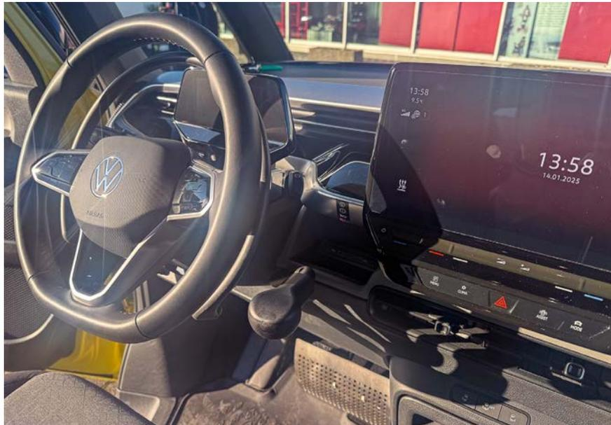
Dank der speziellen Fahrhilfen – Gasring am Lenkrad und Bremshebel – kann Dorothee ihren VW ID. Buzz komplett mit den Händen steuern. Eine individuelle Anpassung für maximale Unabhängigkeit und Sicherheit.
