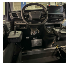
Hightech am Steuer: Die Space-Drive- Joysticksteuerung ermöglicht Benjamin eine präzise und sichere Fahrzeugführung – ganz ohne Lenkrad oder Pedale
