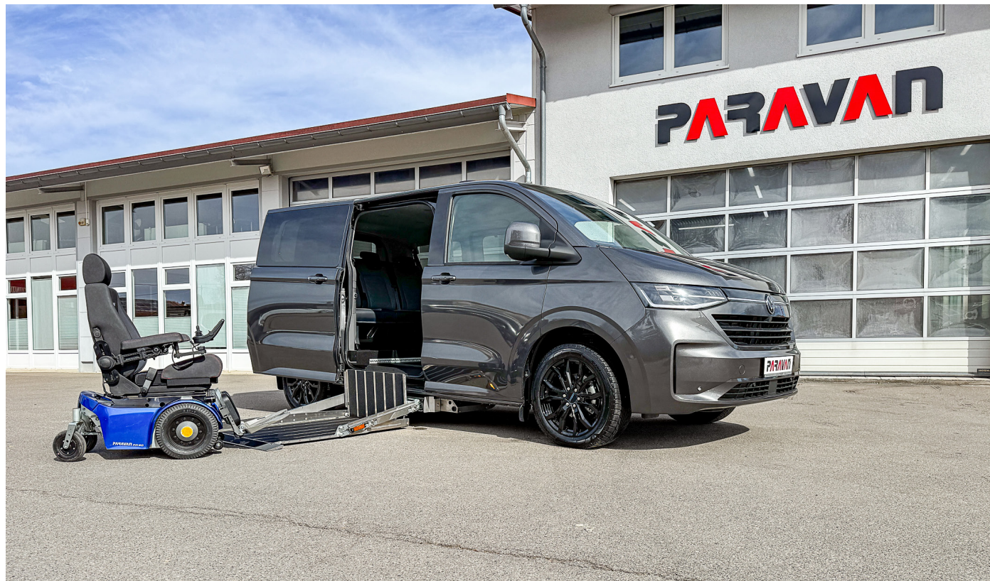
Der Paravan Umbau der VW New Caravelle ermöglicht den komfortablen Einstieg mit dem Rollstuhl über einen Kassettenlift.
