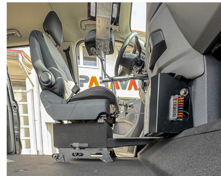
Flexible Fahrerposition: Auf einer Paravan Schnellwechselkonsole montiert, lässt sich der Original-Fahrersitz schnell ausbauen und schafft Platz für den Rollstuhl am Fahrerplatz.
