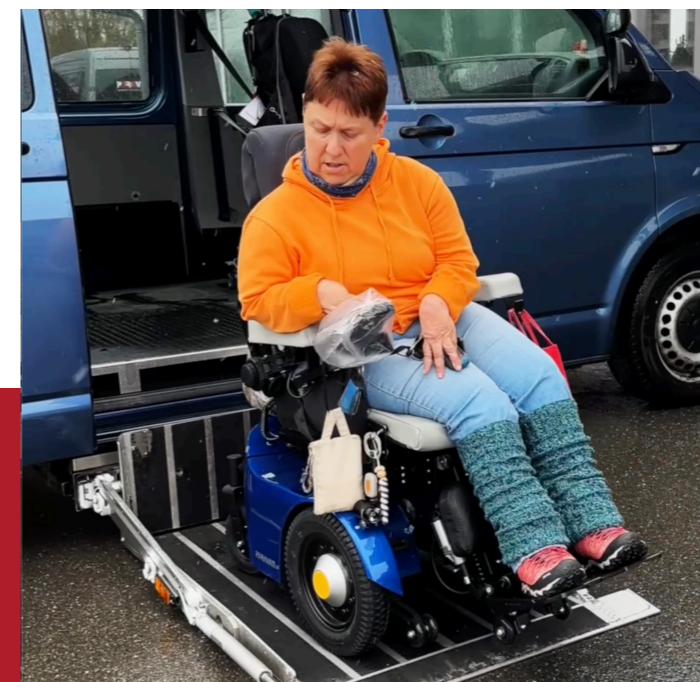
Nahtloser Übergang: Mit dem Kassettenlift gelangt Ulrike direkt vom Rollstuhl ins Fahrzeug – für maximale Selbstständigkeit im Alltag.
