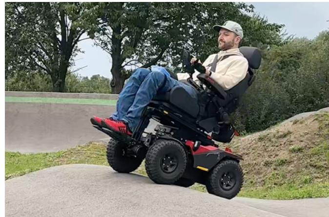
Steigungen im Praxistest: Mit Allradantrieb, Stollenbereifung und hoher Bodenfreiheit ist der PR 4X für anspruchsvolles Gelände ausgelegt.
